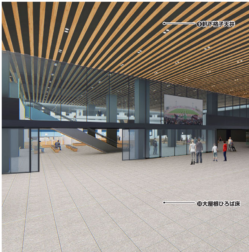
【2階 大屋根ひろば】 ①軒下格子天井：木質系ルーバー ②大屋根ひろば床：磁器質タイル
