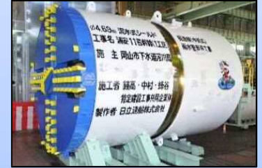
浦安11号幹線雨水管築造工事 (シールド掘進機 外径4,690mm)
