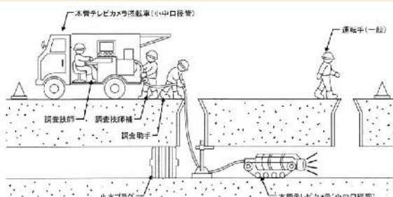
小中口径管テレビカメラ調査作業模式図
