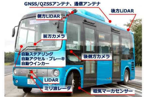
図 自動運転車両への改造（ひたちBRT）
