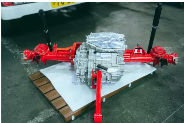
↑AZAPAが手掛けるコンバージョンEVに搭載されるモーターを含むEVの心臓部「Eアクスル」
