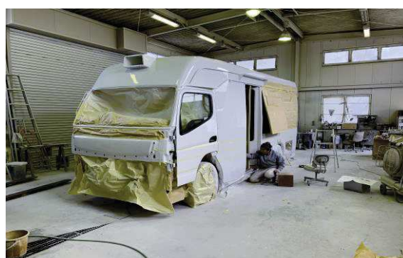
塗装工程(外板、内板塗装施工)
