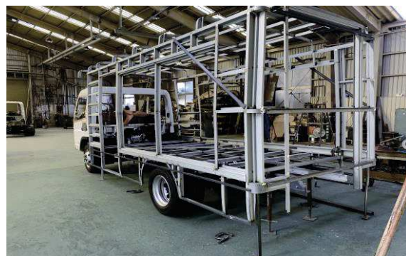
鉄工工程(構体の組み立て等)
