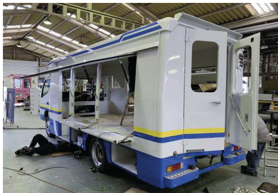
艀装工程①（最終組付工事）
