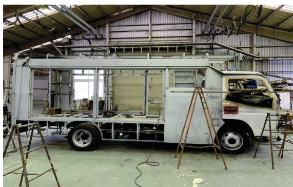
板金工程(外板、内板の貼り付け)
