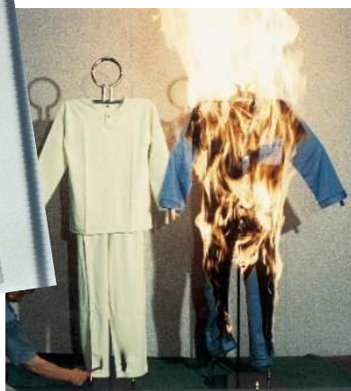
パジャマ（着炎後1分経過の状況）
