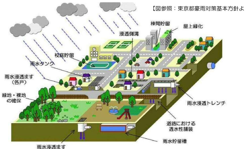
図 2-2. 雨水流出抑制施設の設置イメージ
