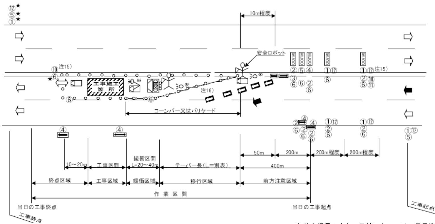
注 1) 舗装修繕工事等のように一定の工事区間をもつものは工事起終点に固定看板(①⑤)を設置する。
