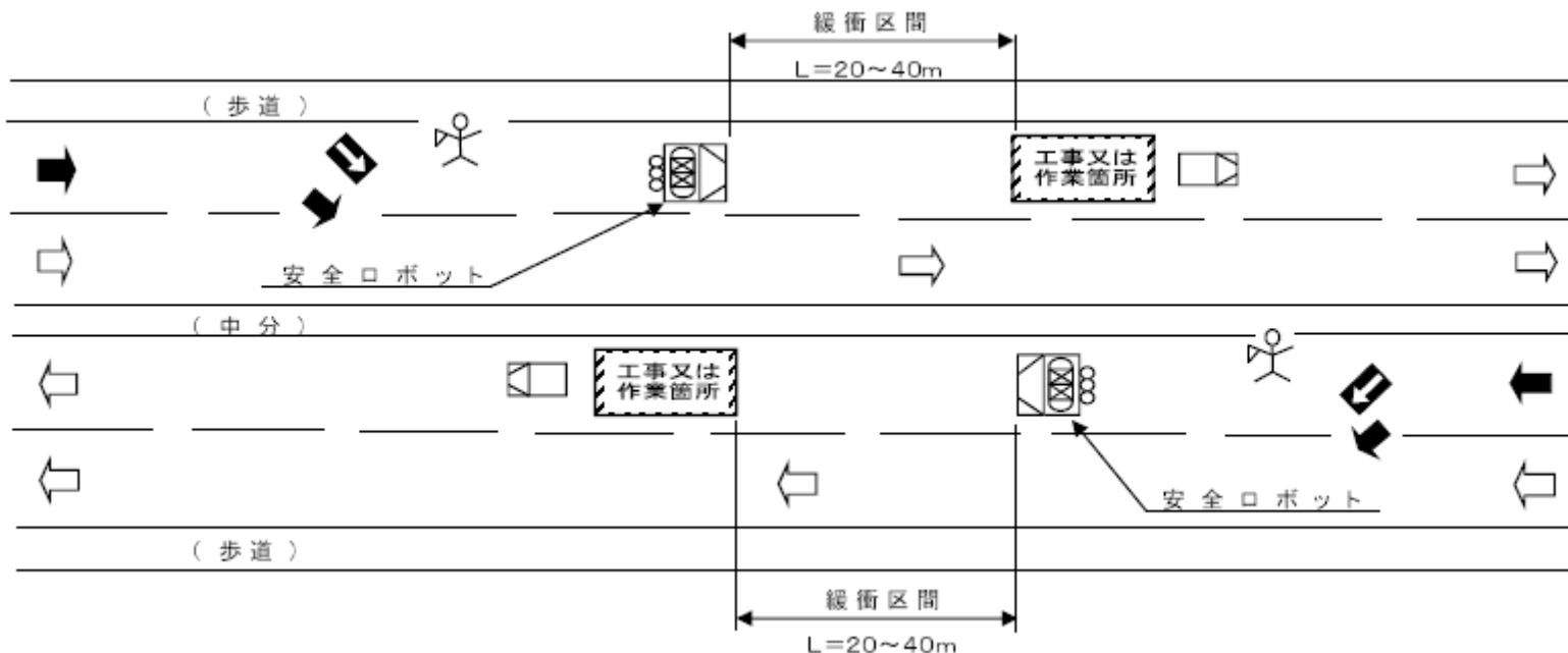
注 1) 標識車は、路面より4m程度の高さとし、高輝度回転灯などを設置して視認性の高いものとする。なお、移動する場合は車両制限令の3.8m以下とする。
