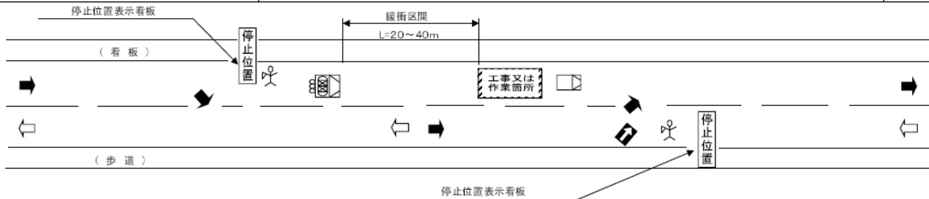
注1) 標識車は、路面より4m程度の高さとし、高輝度回転灯などを設置して視認性の高いものとする。なお、移動する場合は車両制限令の3.8m以下とする。
