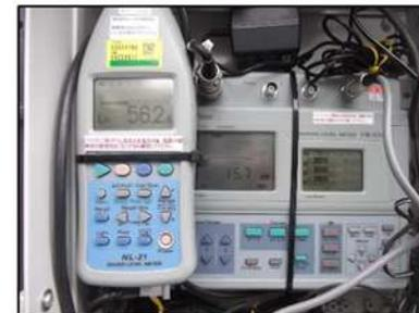
騒音・振動の常時監視は騒音計及び振動計により測定します。
